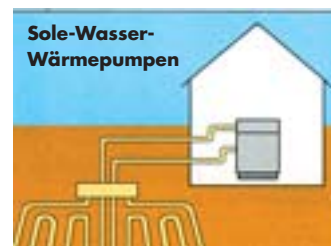
Wärmequelle Erdreich: Horizontaler Erdabsorber
