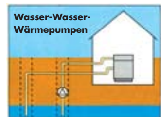
Wärmequelle Erdreich: Wärme aus Grundwasser
